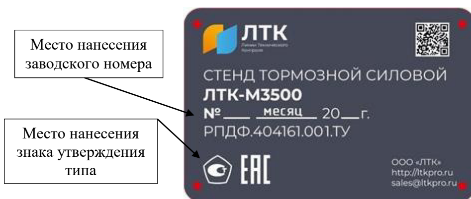
Рисунок 3 – Общий вид маркировочной таблицы, устанавливаемой на шкафу управления
