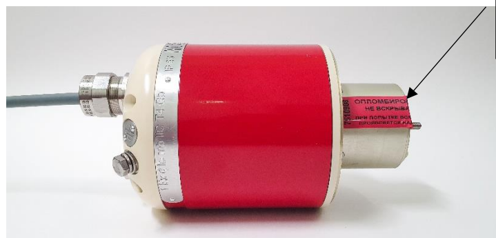
Рисунок 3 – Место пломбирования газоанализаторов «АЛМАЗ-СПЕКТР»
