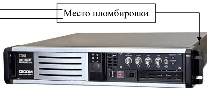
Рисунок 3 – Аппаратура для высокоточного сравнения шкал времени GTR-51
