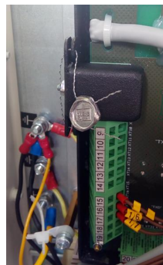
Рисунок 3 - Место нанесения пломбы поверителя на пластину, закрывающую контакты на плате процессорной устройства приема и обработки сигналов «Топаз-273Е»
