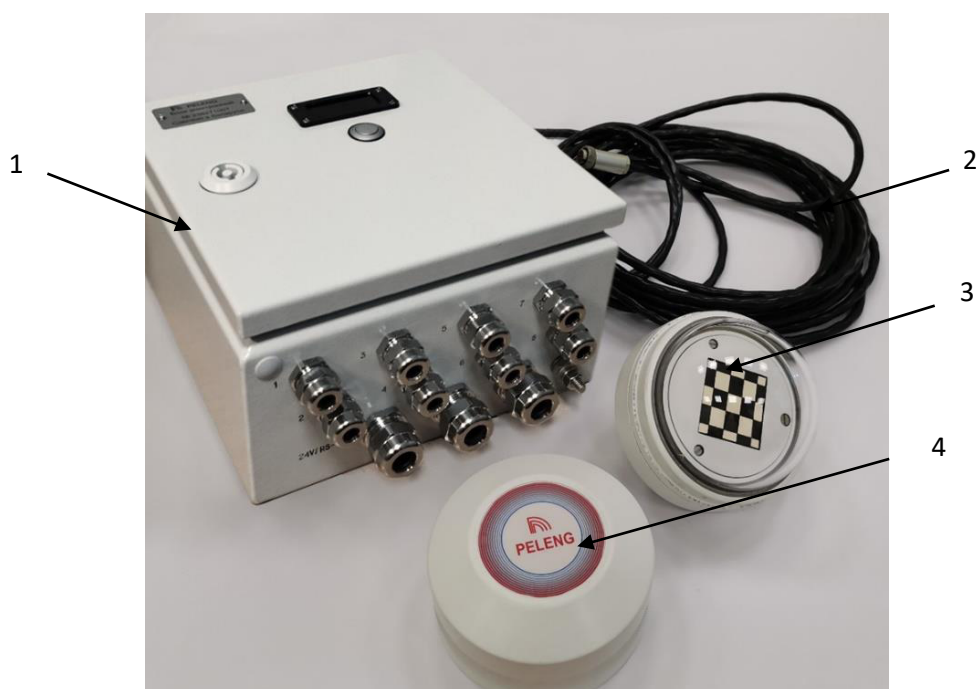
1 – блок электронный; 2 – кабель А (аналоговый); 3 – головка пиранометра; 4 – крышка Рисунок 1 – Общий вид пиранометров с исполнением головок АСТ, АКТ
