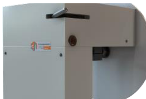
Рисунок 7 - Схема пломбировки копров РКМ-5 (5,5, 22, 50).1 (2).1 (2).1 от несанкционированного доступа
