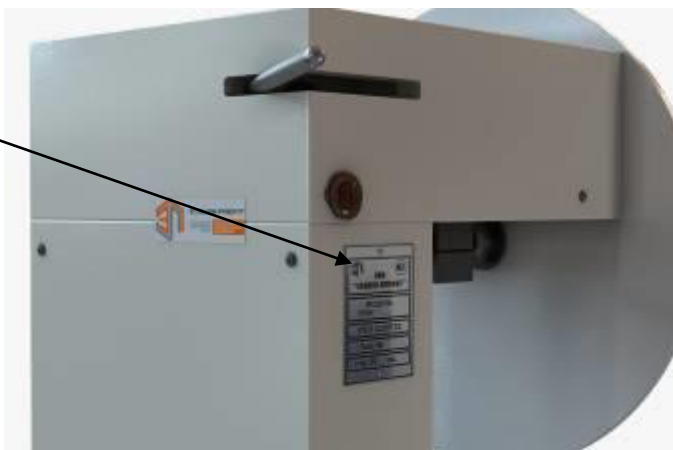
Рисунок 8 – Место нанесения идентификационных данных копров маятниковых РКМ-К
