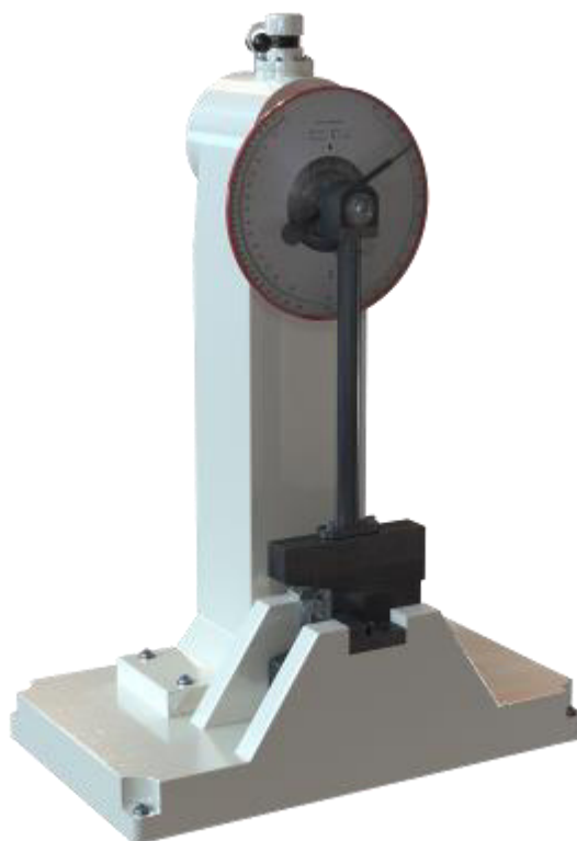
Рисунок - 3 Общий вид копров РКМ-К 300 (450, 500, 800).1.1.1
