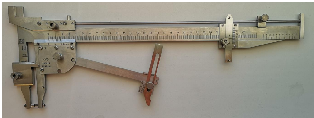
Рисунок 1 – Общий вид штангенциркулей путевых ПШВ-01
