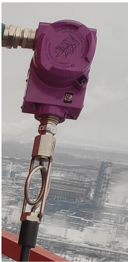
Рисунок 4 – Общий вид преобразователя давления измерительного КМ35
