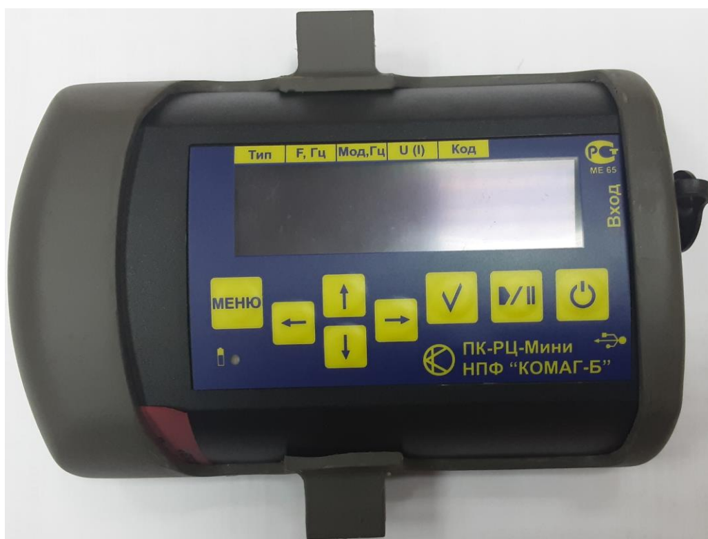
Рисунок 1 – Общий вид приборов комбинированных для измерения сигналов рельсовых цепей ПК-РЦ-Мини
