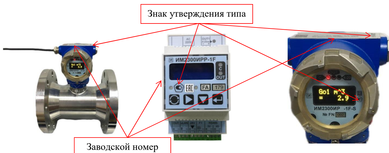
Рисунок 3 – Место нанесения заводского номера и знака утверждения типа
