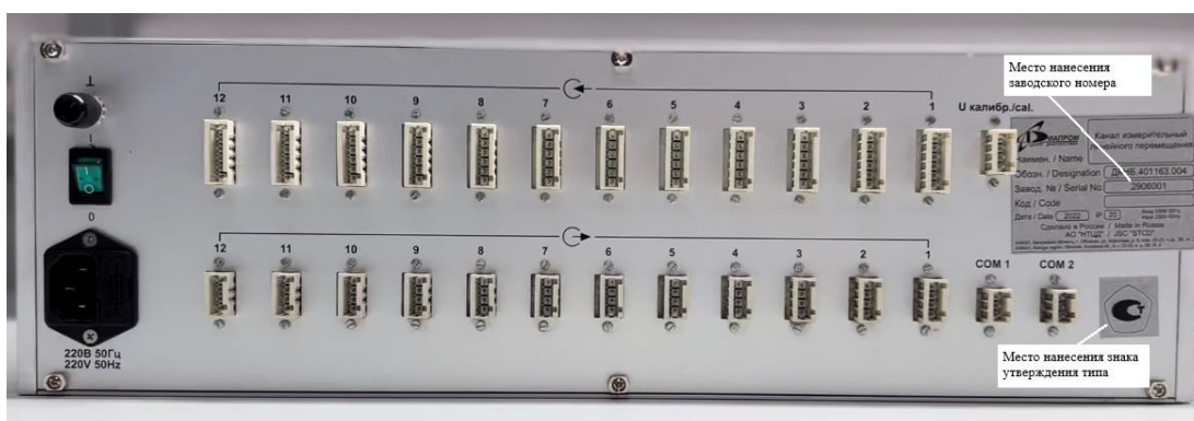
Рисунок 2–Измерители линейных перемещений многоканальные. Вид сзади. Место нанесения наклеек и знака утверждения типа
