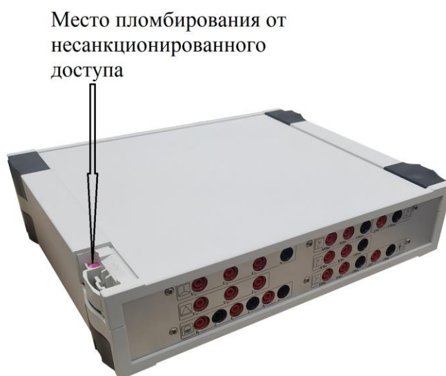
Рисунок 5 - Место пломбирования от несанкционированного доступа
