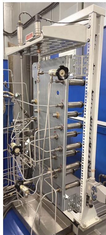
Рисунок 3 - Стойка датчиков давления
