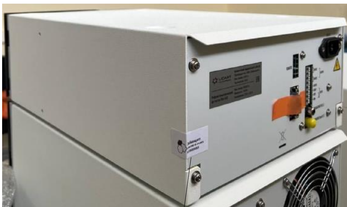
Рисунок 13 – Место пломбирования диодно-матричного детектора DAD-62E
