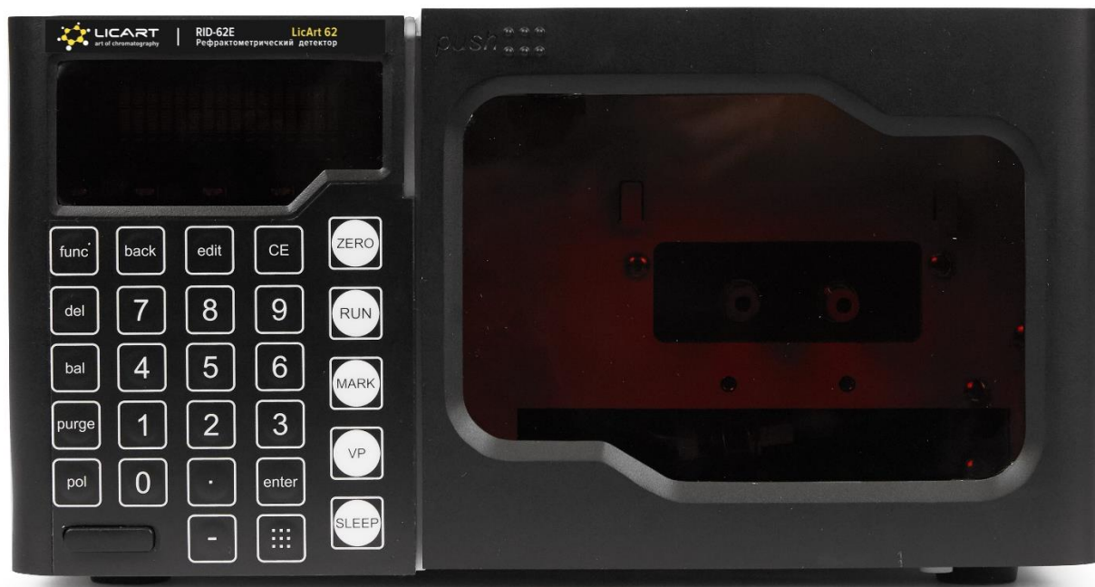
Рисунок 6 – Рефрактометрический детектор RID-62E (лицевая панель)
