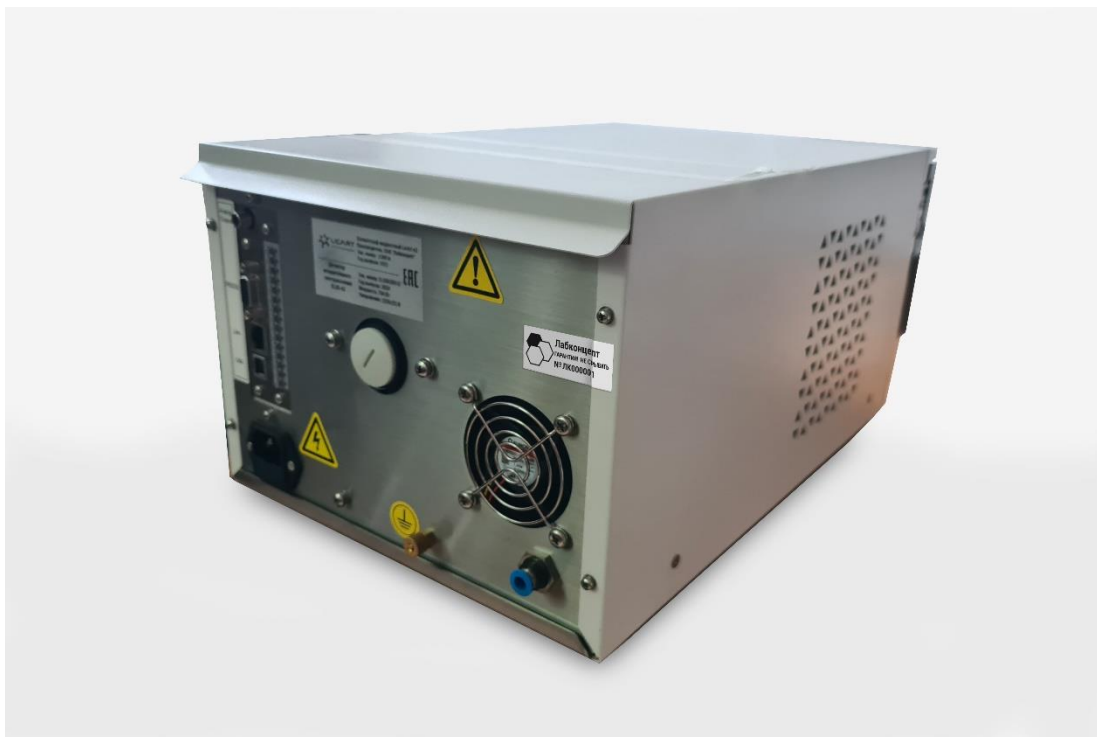
Рисунок 17 – Место пломбирования детектора испарительного светорассеяния ELSD-62
