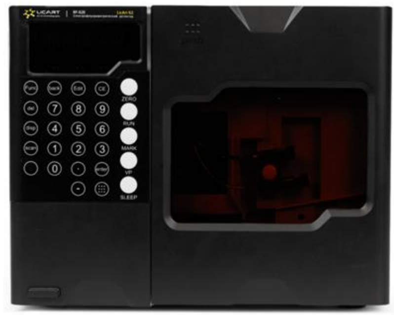
Рисунок 4 – Спектрофлуориметрический детектор RF-62E (лицевая панель)
