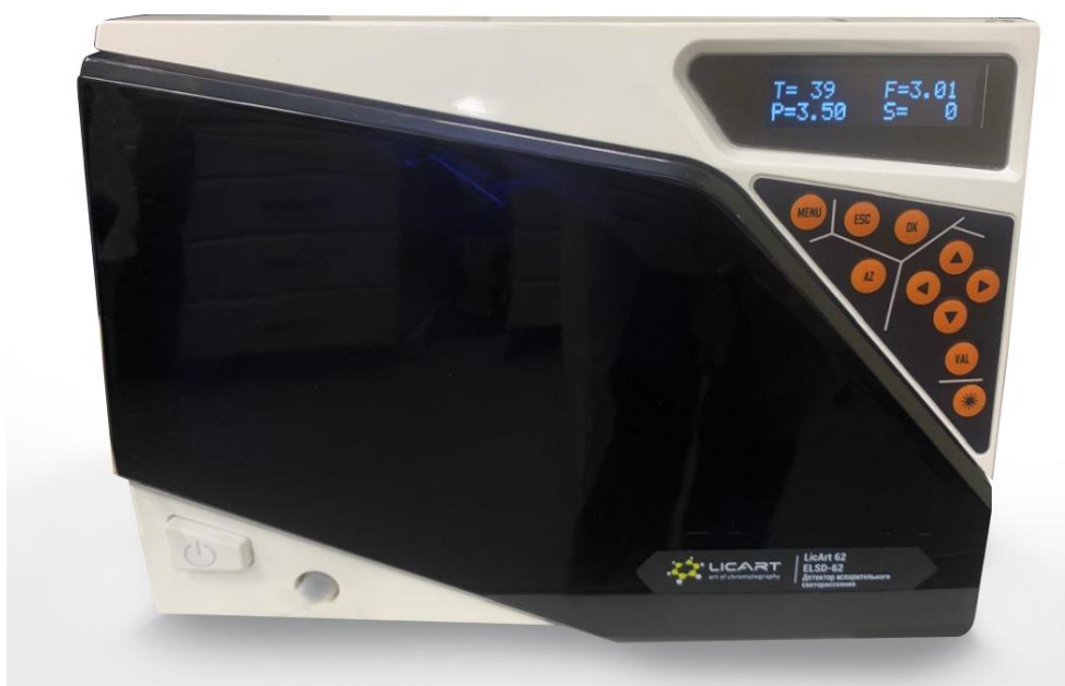
Рисунок 8 – Детектор испарительного светорассеяния ELSD-62 (лицевая панель)
