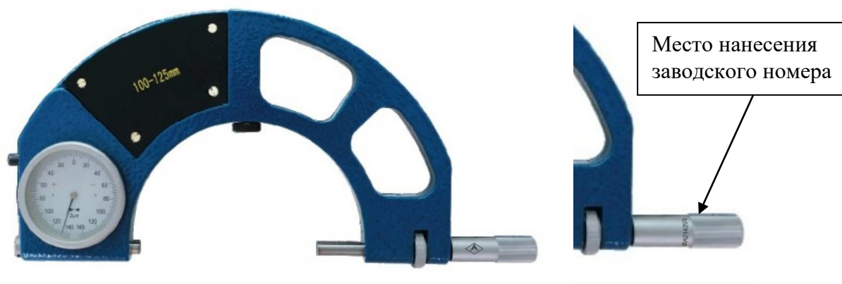
Рисунок 2 – Общий вид скоб с указанием места нанесения заводского номера
