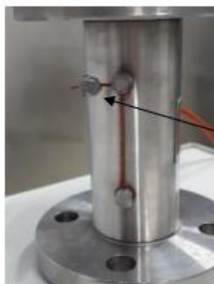
Рисунок 4 – Схема пломбирования от несанкционированного доступа и место нанесения знака поверки в модификации «Р»
