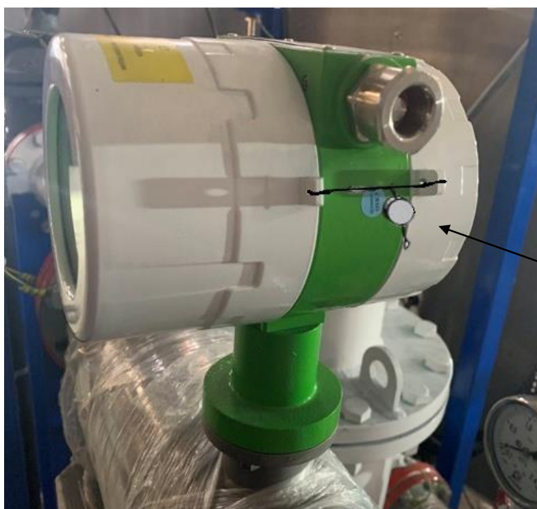
Рисунок 3 – Схема пломбирования от несанкционированного доступа и место нанесения знака поверки в модификации «Э»
