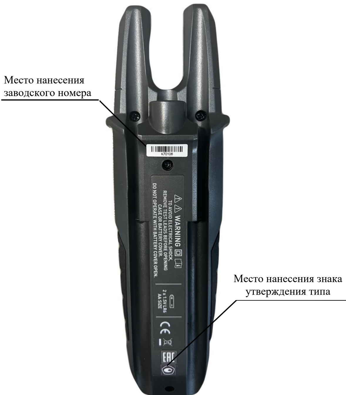
Рисунок 5 – Клещи модификации СМР-200F с указанием места нанесения знака утверждения типа, места заводского номера
