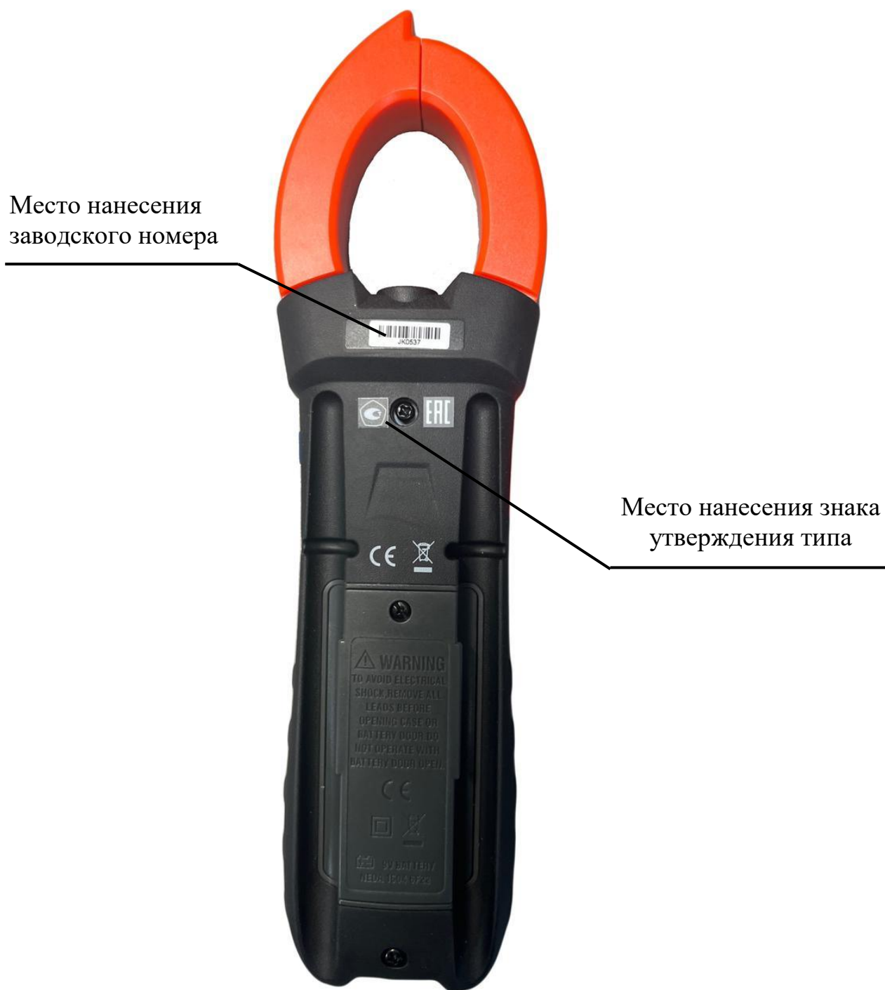
Рисунок 6 – Клещи модификации СМР-3000 с указанием места нанесения знака утверждения типа, места заводского номера
