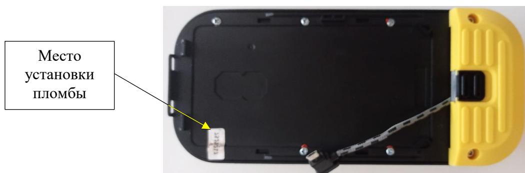
Рисунок 2 – Схема пломбировки модуля
