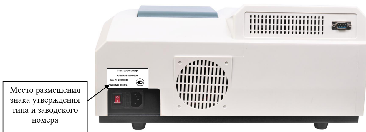
Рисунок 2 – Задняя стенка спектрофотометра Альтаир КФК-200
