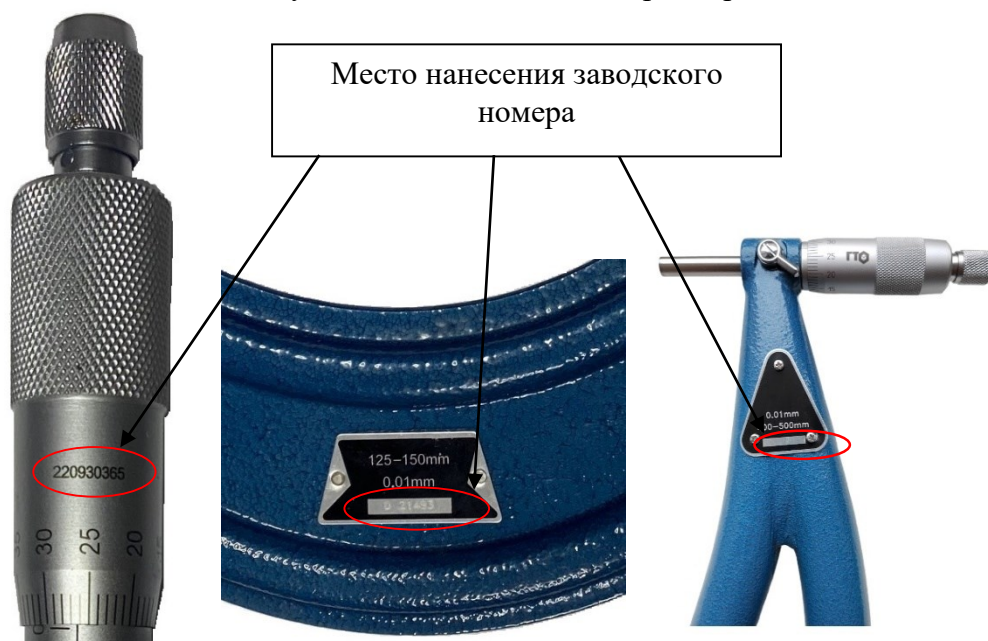
Рисунок 13 – Места нанесения заводского номера
