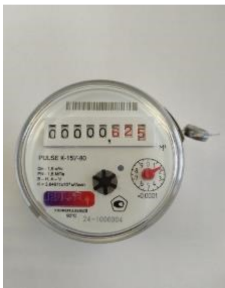
а) счётчик воды PULSE исполнения K
