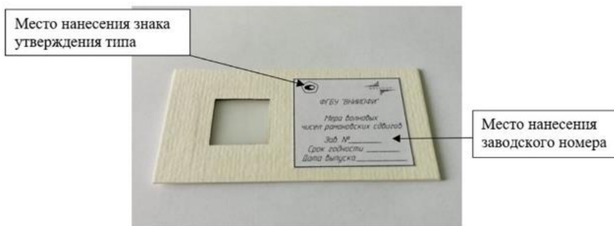
Рисунок 1 – Общий вид меры волновых чисел рамановских сдвигов
