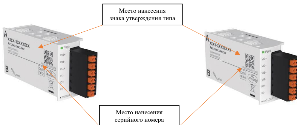
Рисунок 1 – Общий вид модуля модификации GE20-2AD1DA-I
