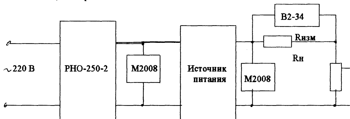
Рис.1. Структурная схема измерения нестабильности выходного напряжения при измерении напряжения питающей сети в режиме стабилизации напряжения
