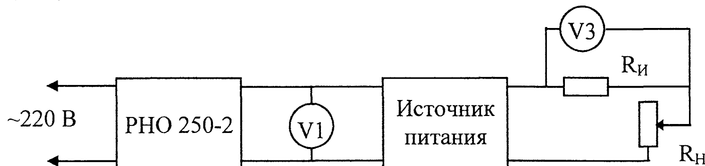
Рис. 4. Структурная схема измерения основной относительной погрешности измерения выходного тока.
