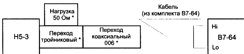
Рисунок 11.1. - Основная схема для калибровки (поверки) прибора в режиме воспроизведения напряжения постоянного тока
