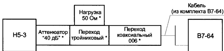
Рисунок 11.2. - Схема для калибровки (поверки) прибора в режиме воспроизведения напряжения постоянного тока с включенным внешним аттенуатором
