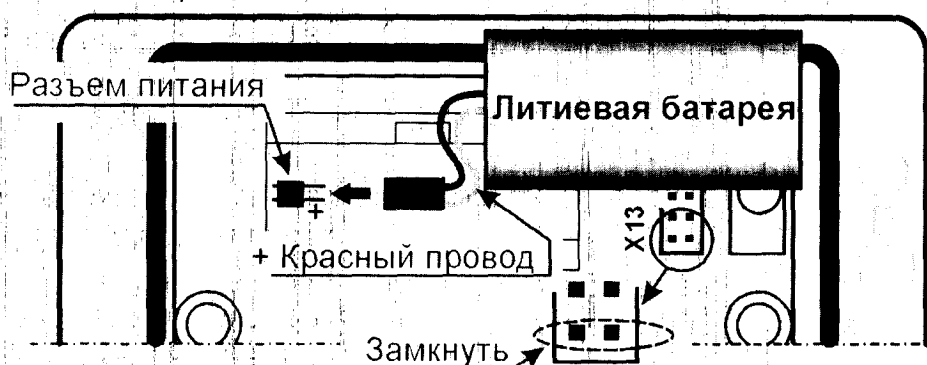
Рис. Л1 – Порядок подключения батареи
