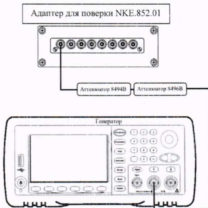
Рисунок 2 – Схема подключения при определении диапазона и абсолютной погрешности измерений отношений амплитуд сигналов на входе приёмника установки
