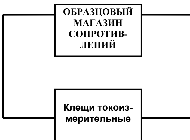
Рисунок 3. Схема соединений при проверке погрешности клещей в режиме измерения сопротивления.
