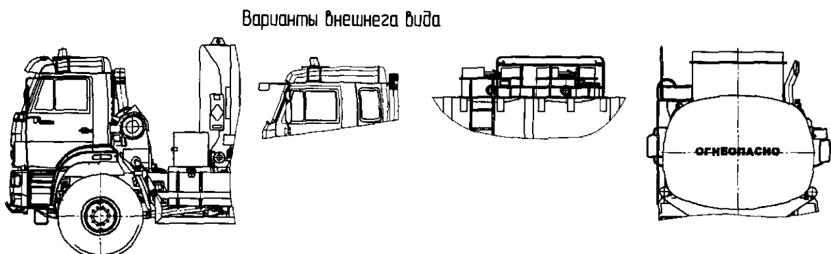
Рисунок 30 – Автотопливозаправщики 6619-30 (АТЗ-20-65222), 6619-31 (АТЗ-22-65222)
