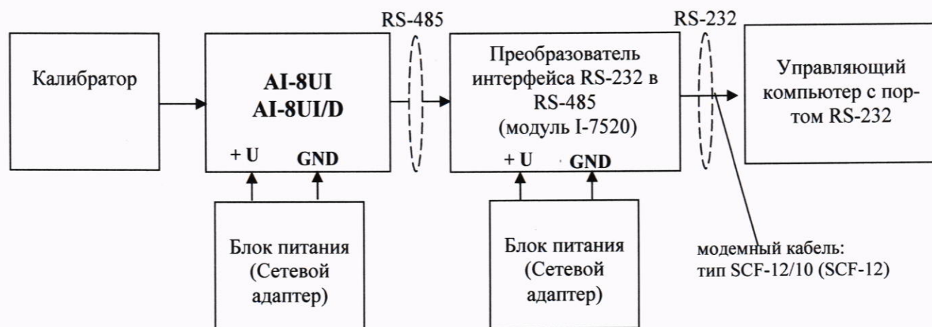
Рисунок 1 - Схема подключения для определения основной приведенной погрешности измерений напряжения постоянного тока и силы постоянного тока
