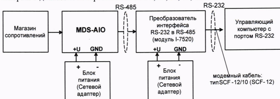
Рисунок 7 – Схема подключения для определения основной приведенной погрешности измерений сопротивления постоянного тока
