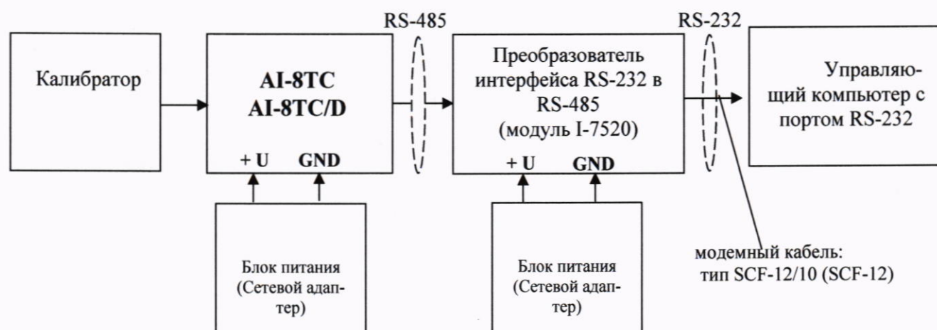
Рисунок 2 - Схема подключения для определения основной приведенной погрешности измерений напряжения постоянного тока и силы постоянного тока
