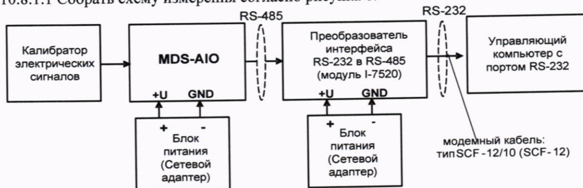
Рисунок 6 – Схема подключения для определения основной приведенной погрешности измерений напряжения постоянного тока и силы постоянного тока
