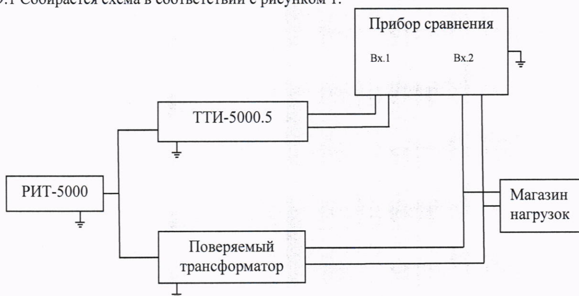
Рисунок 1 – Схема определения токовых и угловых погрешностей трансформаторов
