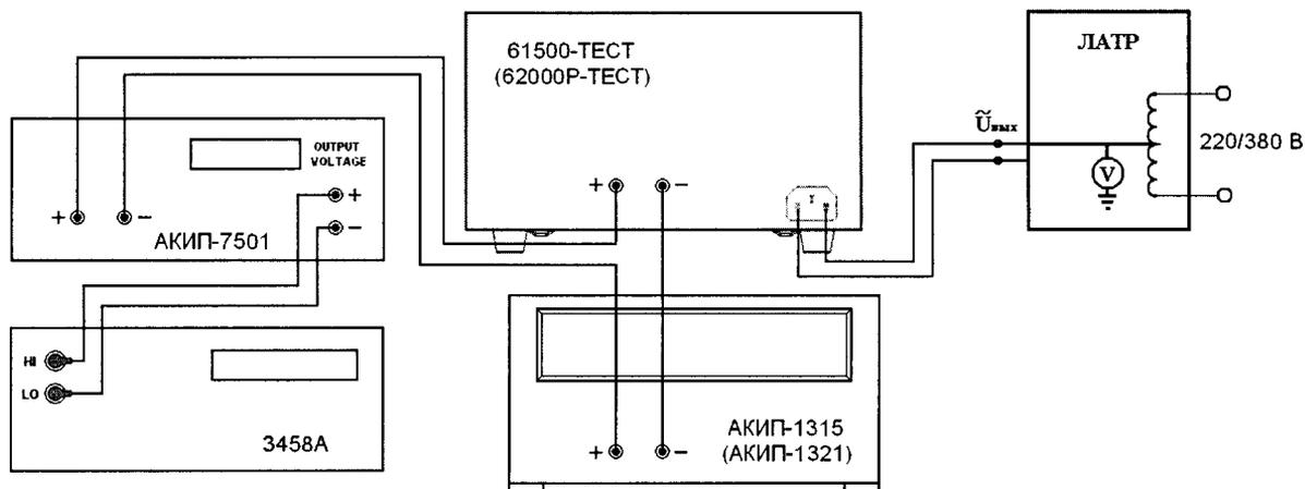
Рисунок 2 – Структурная схема соединения приборов для определения основных метрологических характеристик источников питания в режиме стабилизации силы постоянного и переменного тока.
