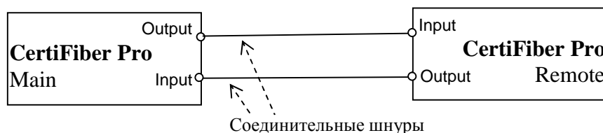
Рисунок 1 - Опробование работы основного блока с удаленным
