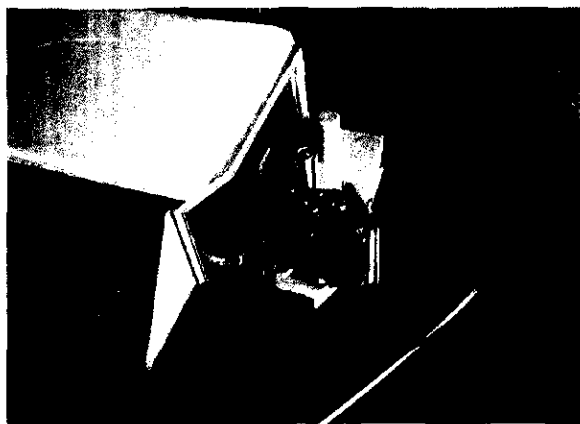
Открыть поворотный механизм печатной головки.
