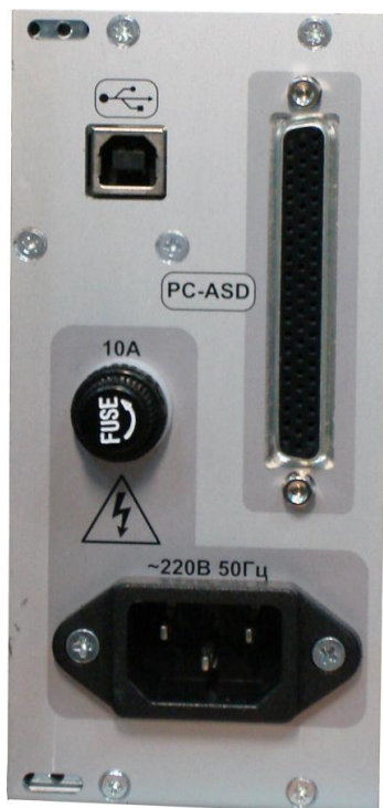
Рисунок 1.4. Блок приборный АСД-3А-САУ. Задняя панель подключения сетевого питания и кабелей интерфейсов с ПЭВМ.
