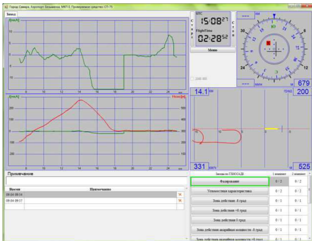
Рисунок 3.3.1.7-36 – Окно работы системы в режиме «Фазирование глиссады»
