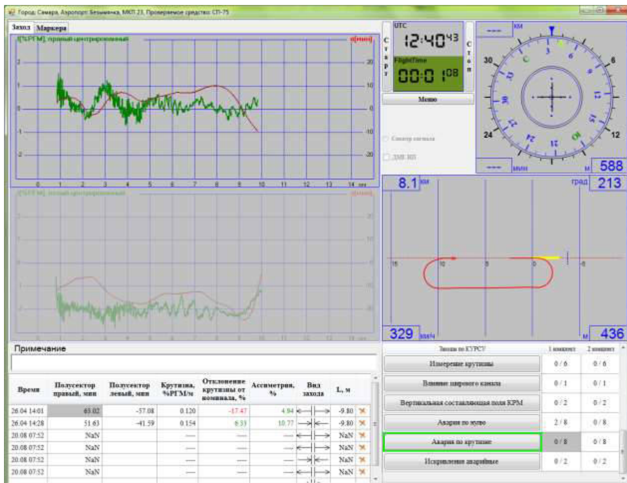
Рисунок 3.3.1.7-33 – Окно работы системы в режиме «Авария по крутизне» для КРМ
