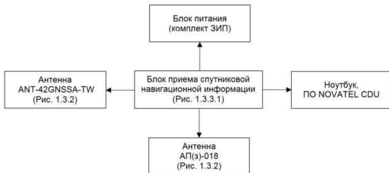
Рисунок 4.1.5.7-3 – Структурная схема подключения бортового оборудования СНС
