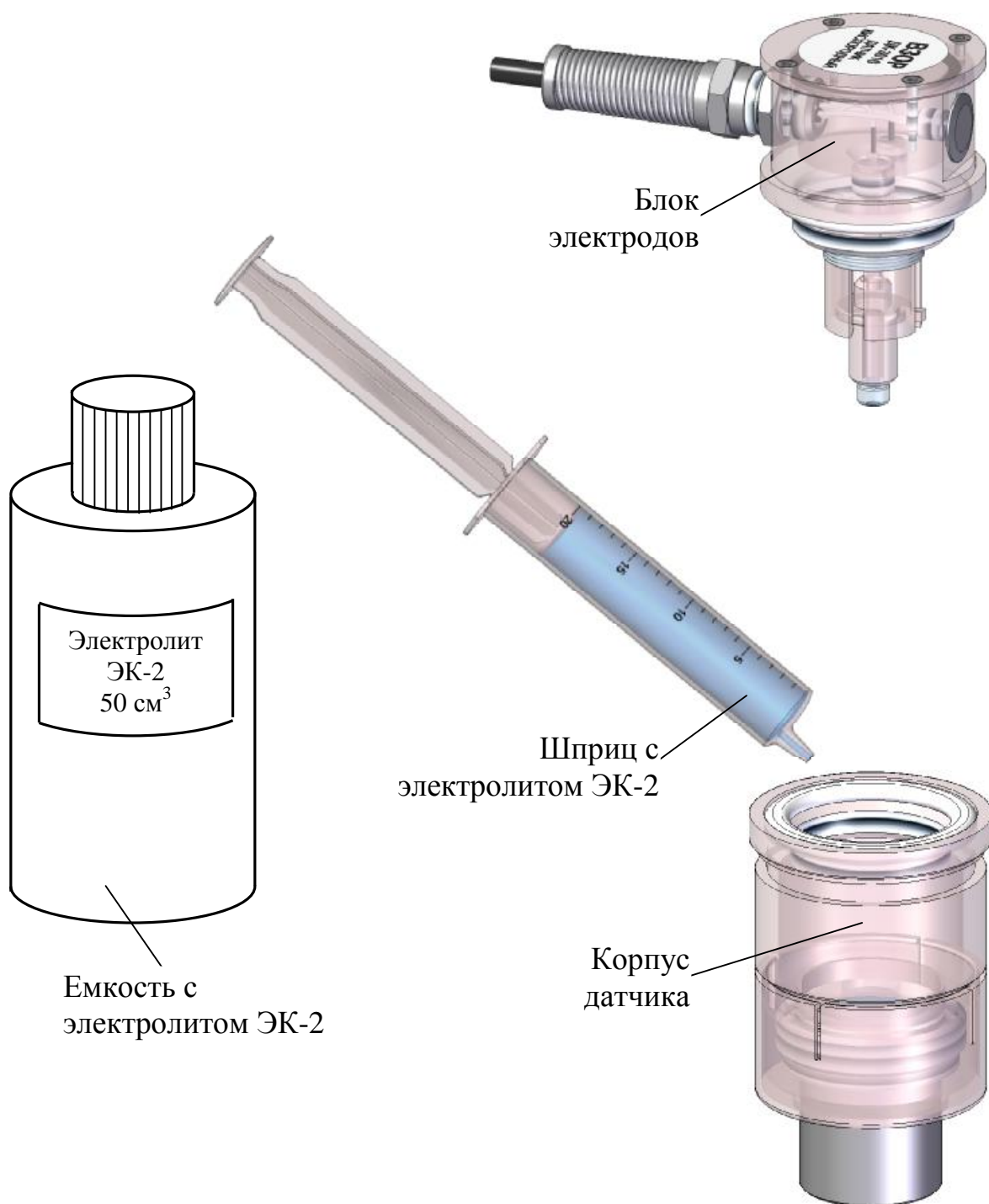
Рисунок 2.1 - Заливка (добавление) электролита ЭК-2
