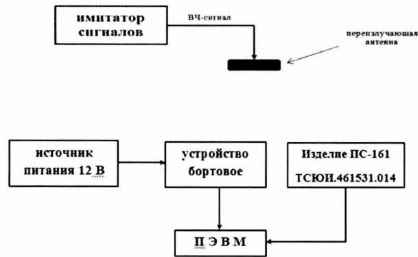
Рисунок 4 – Схема проведения измерений при периодической поверке устройств
