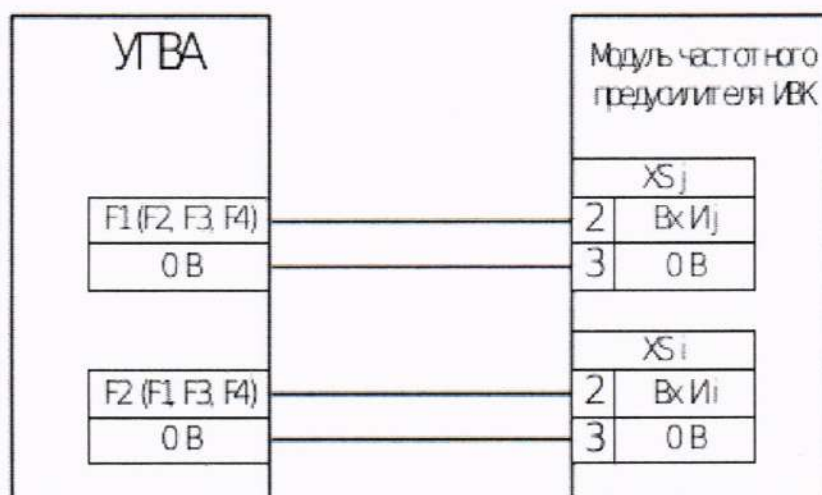
Рисунок А.5 - Схема подключения для определения погрешности измерений отношения количества импульсов за интервал времени (один ЭПР (КПР))
