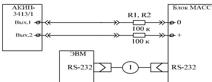
АКИП-3413/1 – генератор импульсов;
