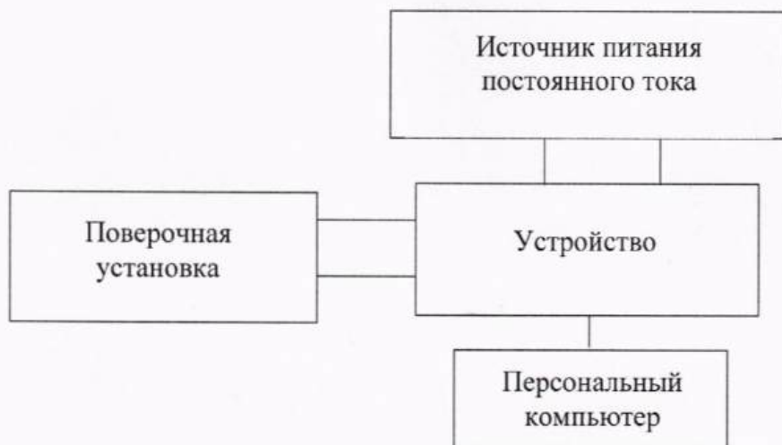
Рисунок 4а – Схема подключений для проверки устройств при определении основной погрешности измерений активной, реактивной электрической энергии и электрической мощности, приведенной к диапазону измерений основной погрешности измерений фазного напряжения переменного тока, приведенной к диапазону измерений основной погрешности измерений силы переменного тока, абсолютной основной погрешности измерений частоты напряжения переменного тока с напряжением питания постоянного тока
