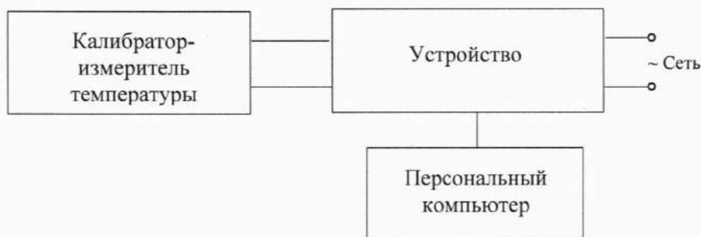
Рисунок 2б – Схема подключений для проверки устройств при погрешности воспроизведений силы постоянного тока для устройств с напряжением питания переменного тока
