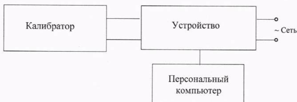
Рисунок 3б – Схема подключений для проверки устройств при погрешности воспроизведений силы постоянного тока для устройств с напряжением питания переменного тока
