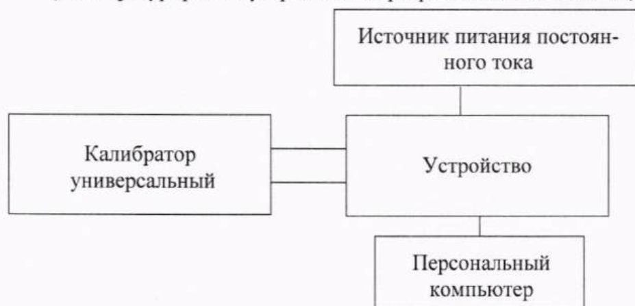
Рисунок 1а – Схема подключений для проверки устройств при определении погрешности измерений силы переменного и постоянного тока/силы дифференциального тока (тока утечки), приведенной к диапазону измерений основной погрешности измерений напряжения переменного и постоянного тока для устройств с напряжением питания постоянного тока
