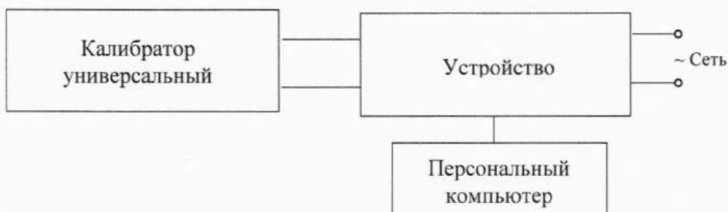
Рисунок 1б – Схема подключений для проверки устройств при определении погрешности измерений силы переменного и постоянного тока/силы дифференциального тока (тока утечки), приведенной к диапазону измерений основной погрешности измерений напряжения переменного и постоянного тока для устройств с напряжением питания переменного тока
