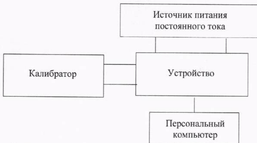
Рисунок 3а – Схема подключений для проверки устройств при определении погрешности воспроизведений силы постоянного тока для устройств с напряжением питания постоянного тока
