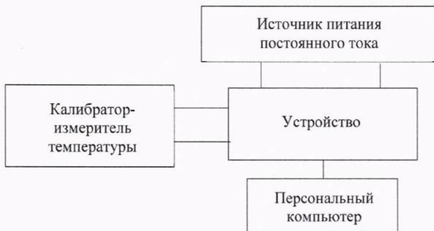
Рисунок 2а – Схема подключений для проверки устройств при определении погрешности воспроизведений силы постоянного тока для устройств с напряжением питания постоянного тока
