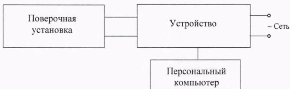
Рисунок 4б – Схема подключений для проверки устройств при определении основной погрешности измерений активной, реактивной электрической энергии и электрической мощности, приведенной к диапазону измерений основной погрешности измерений фазного напряжения переменного тока, приведенной к диапазону измерений основной погрешности измерений силы переменного тока, абсолютной основной погрешности измерений частоты напряжения переменного тока с напряжением питания переменного тока
