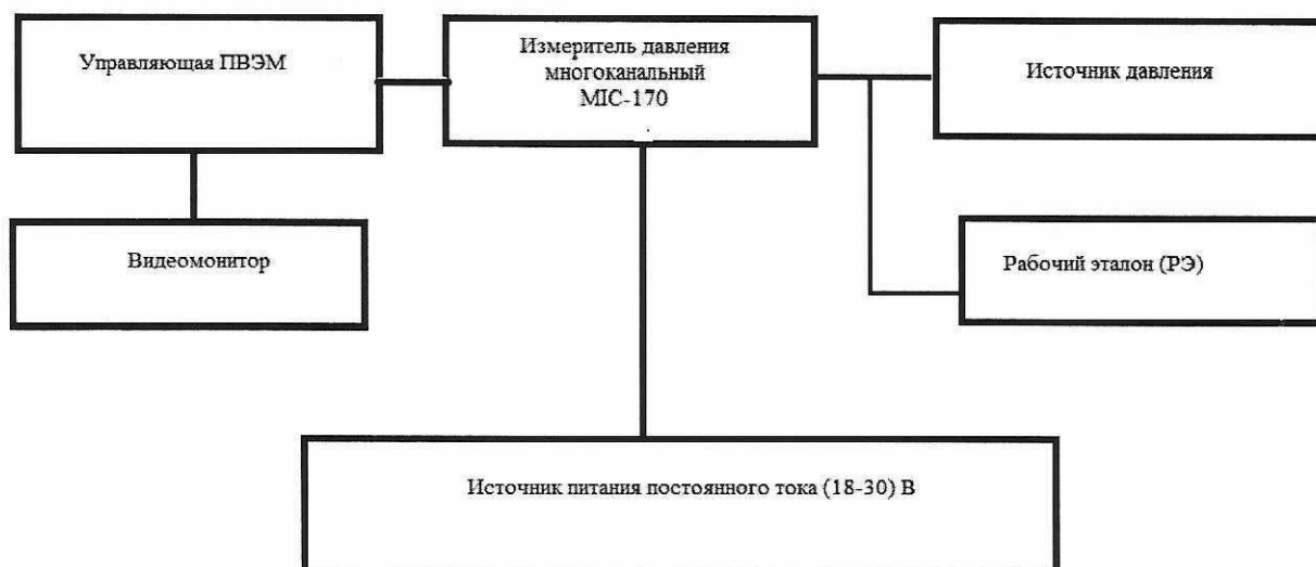
Рисунок В.1 – Схема соединения при определении метрологических характеристик МПС-170 (МПС-170Т)
