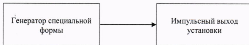
Рисунок 1. Схема подключения при поверке канала измерения времени
