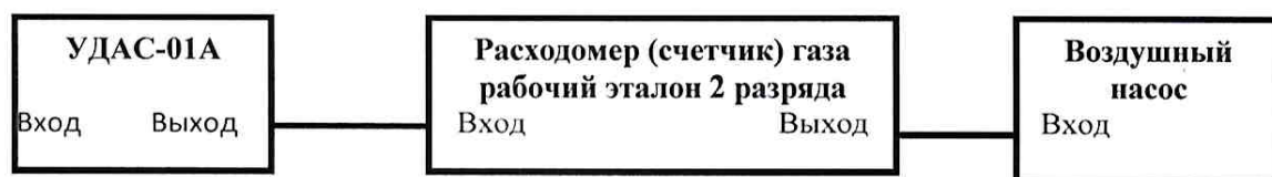
Рисунок 1 - Схема подключения для измерения объёмной активности радиоактивных аэрозолей «УДАС-01А» к расходомеру (счетчик) газа – рабочему эталону 2-го разряда
