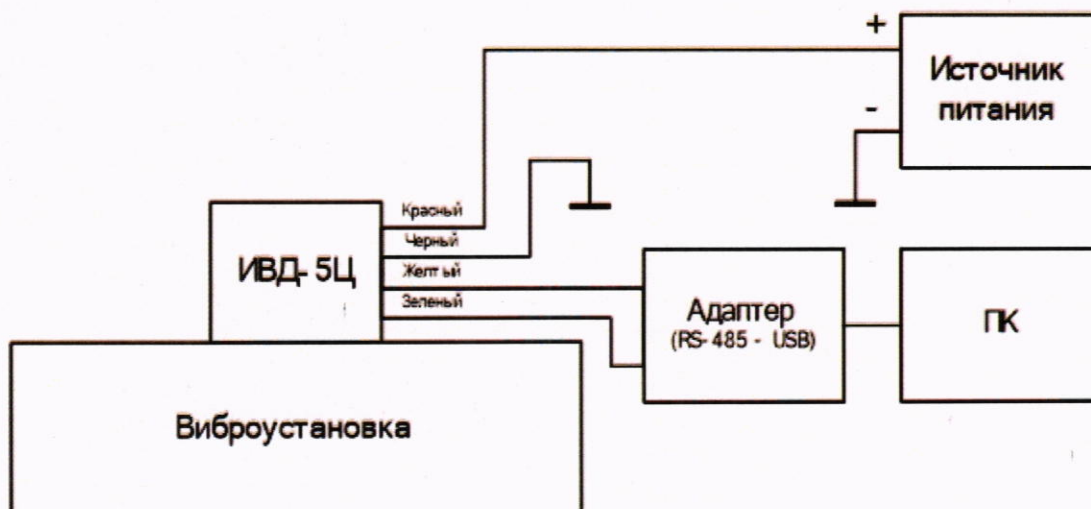
Рисунок 1 – Схема подключения датчиков ИВД-5Ц
