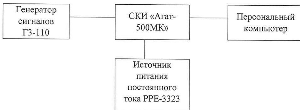
Рисунок 2– Схема подключения для определения приведенной погрешности систем СКИ «Агат-500МК» на диапазоне измерений от 200 Гц до 8000 Гц
