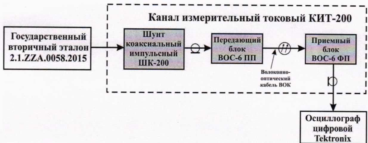
Рисунок 1 – Схема соединений при проведении опробования канала и проверки его метрологических характеристик
