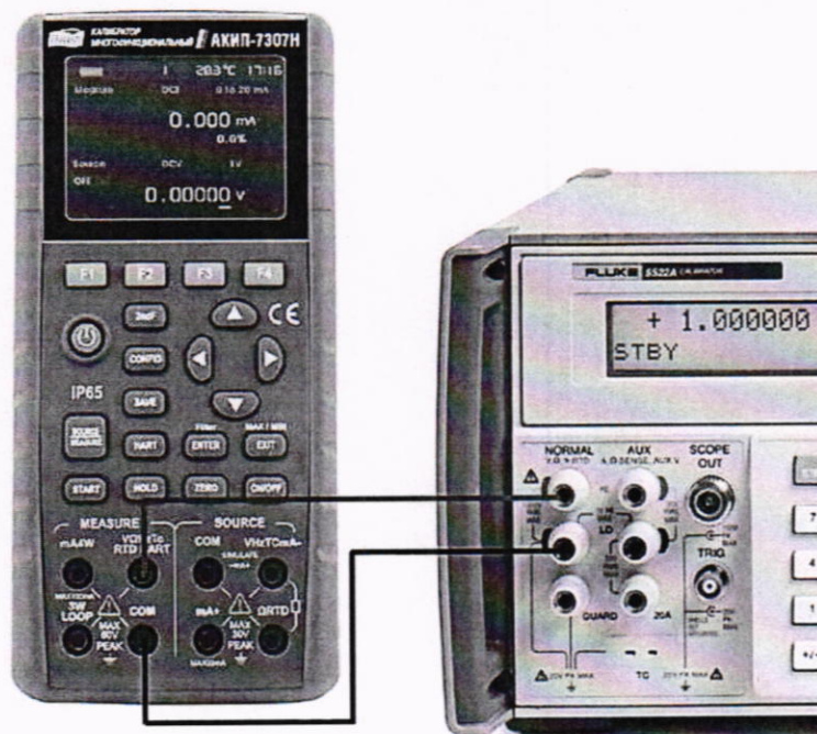
Рисунок 1 – Схема соединения приборов при определении погрешности измерения напряжения постоянного тока и частоты.
