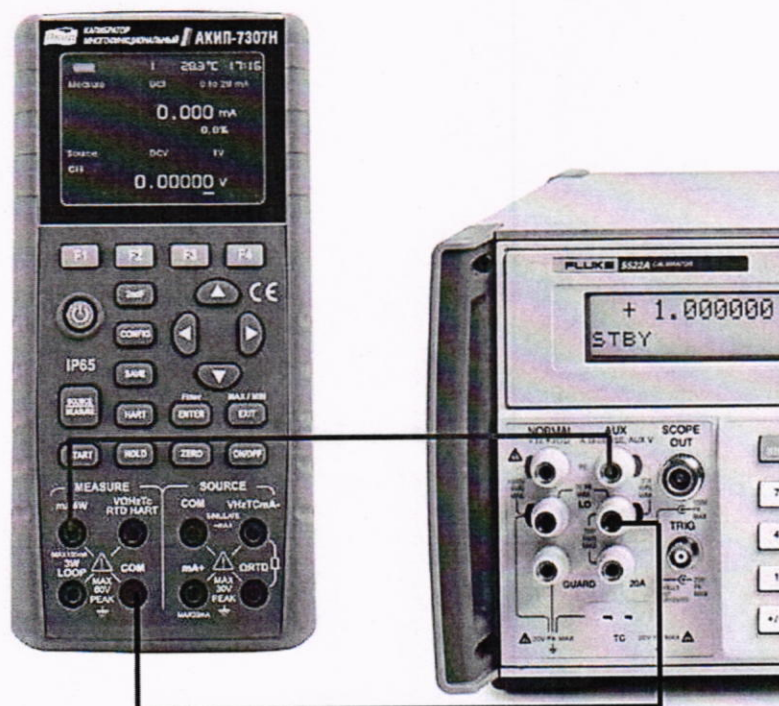
Рисунок 3 – Схема соединения приборов при определении погрешности измерения силы постоянного тока.
