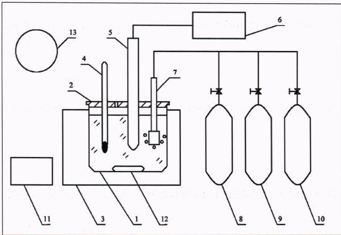
1 – стакан/сосуд; 2 - крышка; 3 - термостат; 4 - термометр; 5 - датчик;
